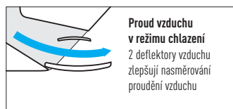
Ideální výstup proudu vzduchu v režimu chlazení
