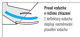
Ideální výstup proudu vzduchu v režimu chlazení
