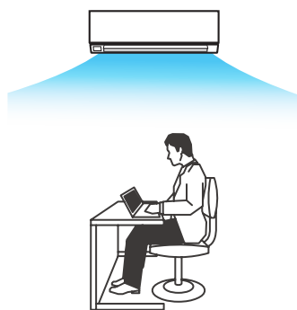
Ideální výstup proudu vzduchu v režimu chlazení
