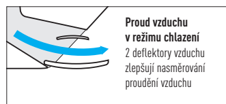
Ideální výstup proudu vzduchu v režimu chlazení
