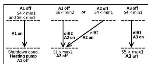
A2 = [(S4 > min1 & S4 > S1 + diff2) or (S6 > min2 & S6 > S1 + diff2) & S1 < max2] & TP<sub>Req. DHW</sub>
