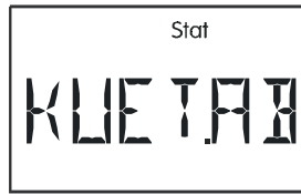
Kolektor – Nadměrná teplota – vypnutí je aktivní
