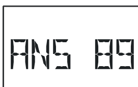
Analogový stupeň zobrazen pouze, když je aktivován analogový výstup
