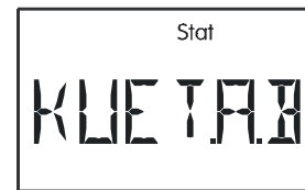
Odpojení kolektoru – nadměrná teplota - aktivní (žádná závada)
